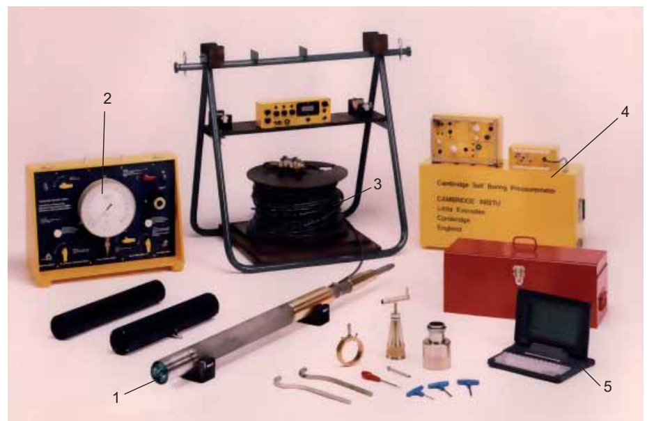
Рис. 8. Самозабуривающийся прессиометр [35]: 1 — зонд; 2 — панель управления давлением; 3 — кабель; 4 — регистратор; 5 — компьютер
