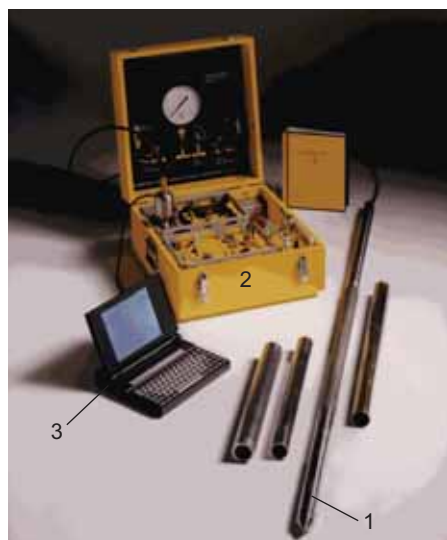
Рис. 9. Вдавливаемый конусный пенетромтр [9]: 1 — зонд; 2 — регистратор; 3 — компьютер
