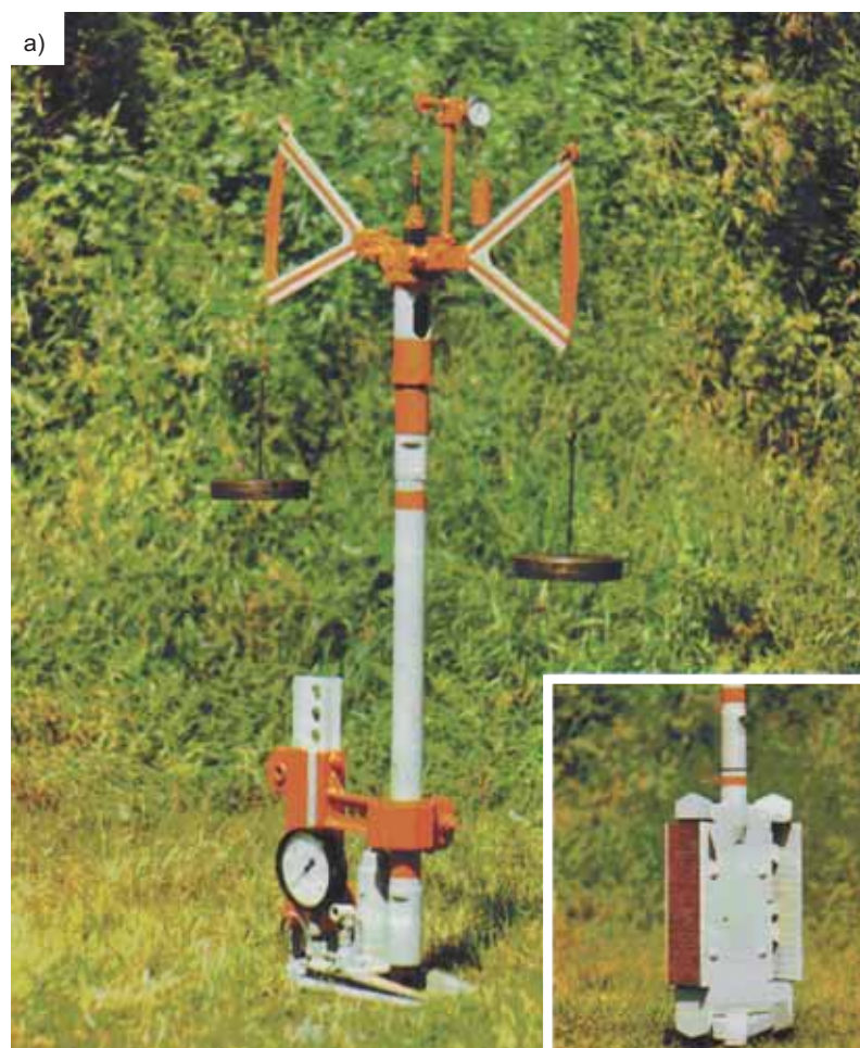
Рис. 10. Прессиометры, разработанные в ПНИИСе: а — ЛП-14С; б — ЛП-12М [6]: 1 — груз; 2 — штамп; 3 — шестерни; 4 — рейка; 5 — нагрузочное устройство; 6 — штурвал; 7 — прогибомер; 8 — штанги; 9 — корпус; 10 — штамп; 11 — рейка
