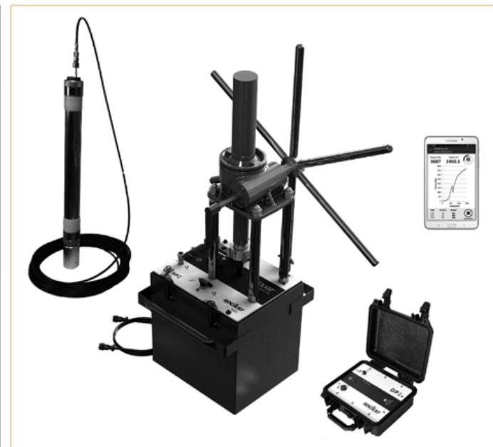
**Рис. 2. Прессиометр конструкции ТЕХАМ фирмы RocTest.**
