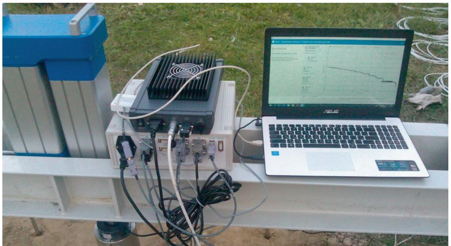
Рис. 8. Комплект для испытаний грунтов винтовым штампом, использованный при работах в г. Грозном
