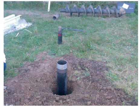
Рис. 6. Установка двух анкеров и штампа в скважине без обсадной трубы на полигоне ООО «НПП «Геотек»» в г. Пензе
