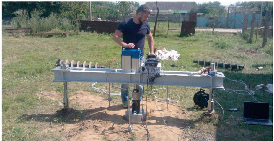
Рис. 7. Испытания винтовым штампом в г. Грозном
