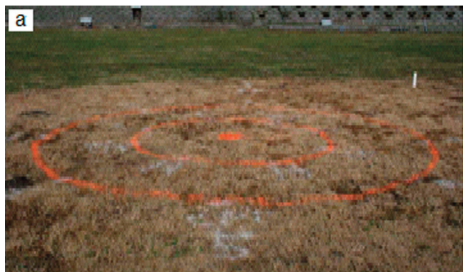
Рис. 1. Расположение экспериментальных геологических скважин для статического зондирования на фотографии (а) и на схеме (б) (по [14])
