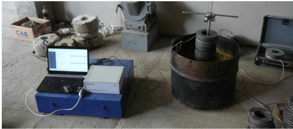
Рис. 5. Установка для испытаний с ручным режимом нагружения: 1 – устройство для создания крутящего момента; 2 – грузы; 3 – лоток с песчаным грунтом; 6 – измерительная система
