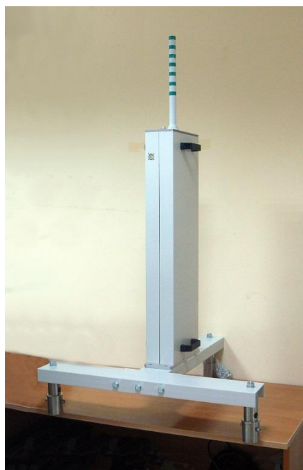
Рис. 7. Автоматизированная установка для комплексных испытаний грунтов: а – общий вид; б – конструктивное решение; 1 – блок силового нагружения; 2 – Т-образная рама; 2 – опоры для крепления анкеров; 4 – винт; 5,6 – шаговый двигатель и датчики силы вертикальной нагрузки; 7,8 – шаговый двигатель и датчик крутящего момента; 9 – верхняя опорная плита; 10 – нижняя опорная плита; 11 – направляющие
