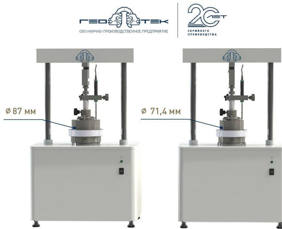
В продолжение цикла статей о лабораторных методах испытаний дисперсных грунтов рассматриваются консолидационные испытания в приборах компрессионного сжатия, методики определения параметров фильтрационной консолидации и ползучести, принятые в практике инженерно-геологических изысканий, а также технические требования к оборудованию для подобных испытаний.
