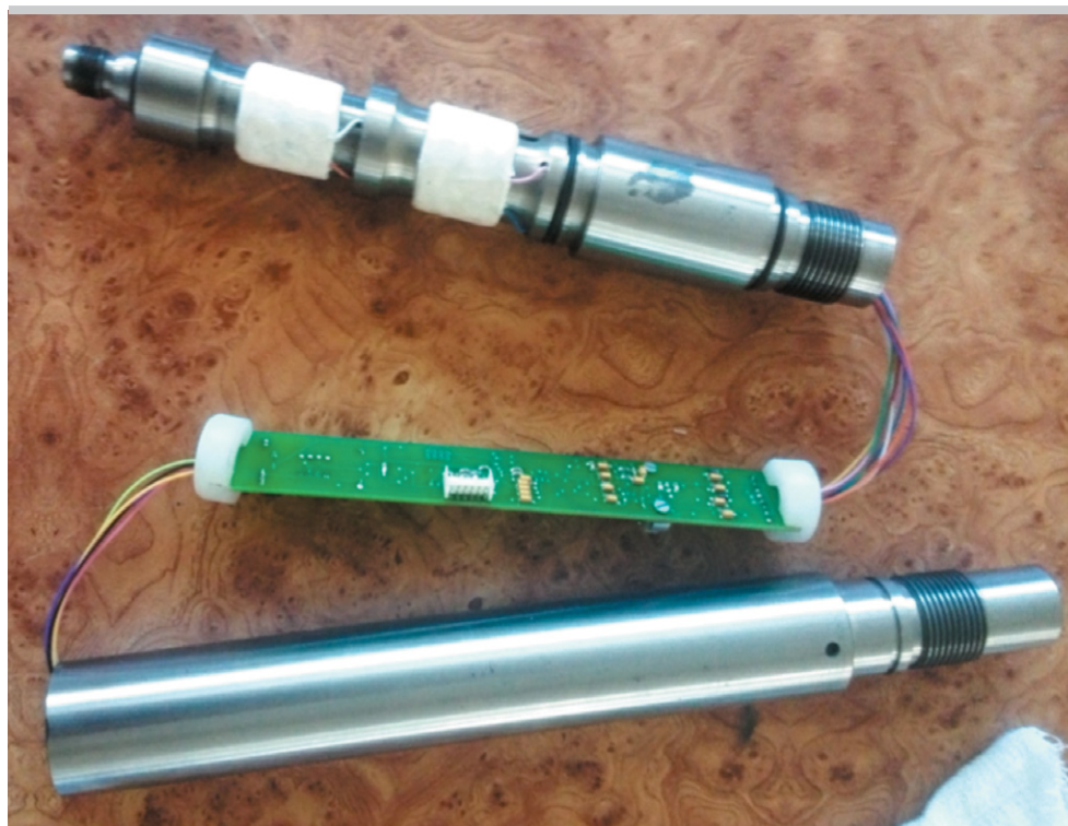
Рис. 2. Тензометрические элементы и плата электроники зонда
