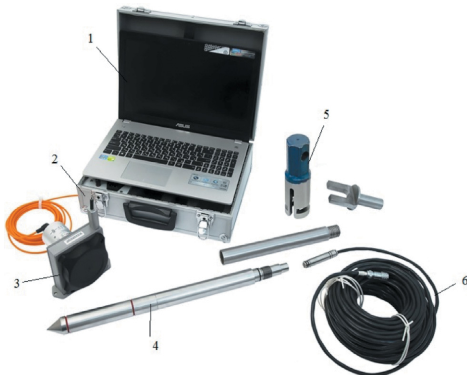
Рис. 1. Комплект СРТ зонда: 1 – ноутбук; 2 – блок электроники; 3 – дальномер с кабелем; 4 – зонд; 5 – вилка и оголовник; 6 – кабель зонда
