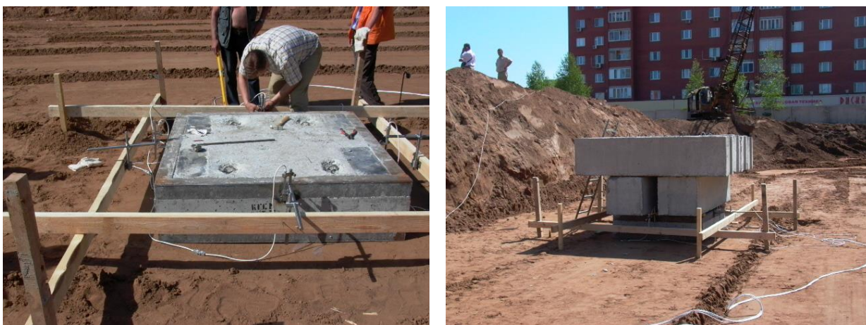
Рис. 4. Штамп площадью 22500 см 2 и нагружение штампа весом фундаментных блоков.
