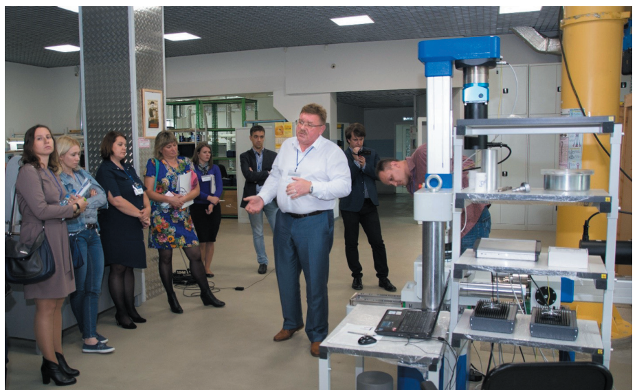
Рис. 3. Демонстрация установки для испытаний скальных пород в условиях одноплоскостного среза
