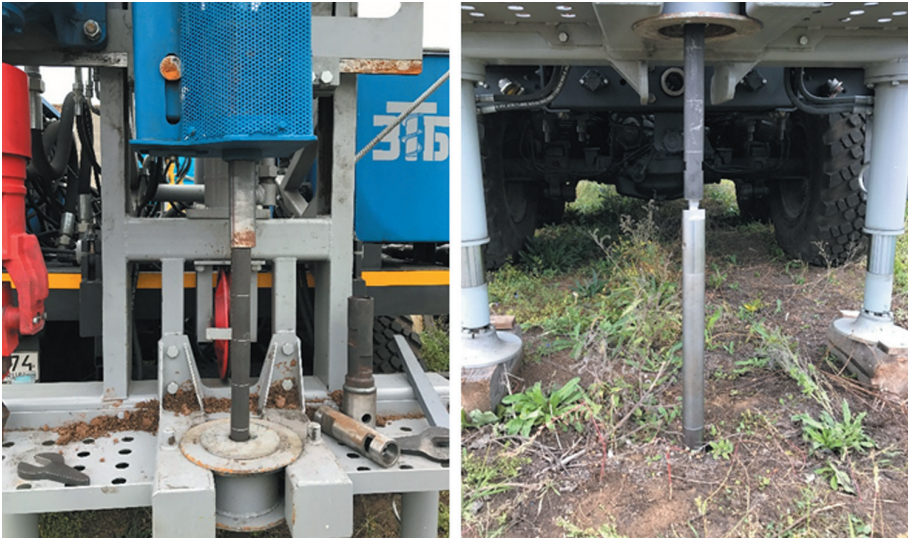
Рис. 11. Динамические испытания пробоотборником по ASTM D 1586 [7]
