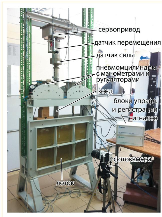
Рис. 1. Стенд для испытаний в условиях плоской деформации
