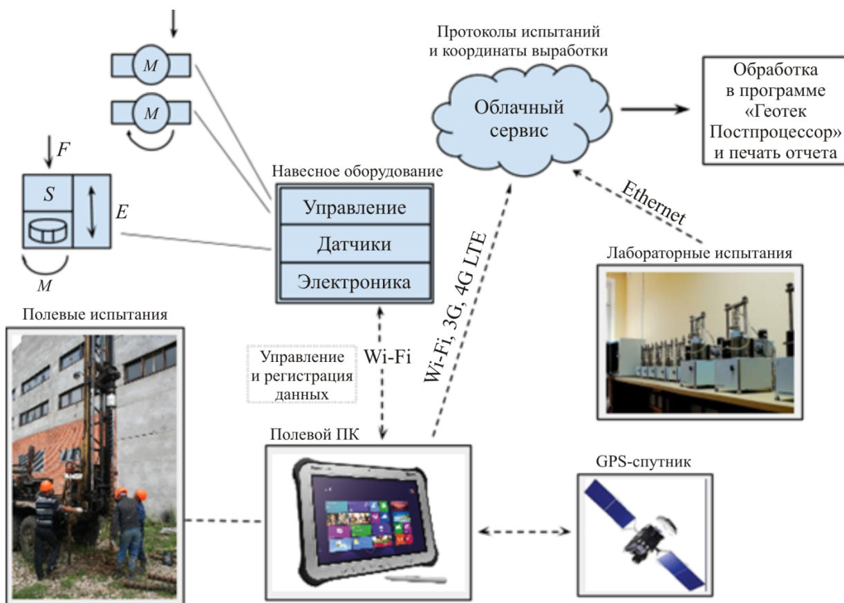
Рис. 1. Схема перемещения данных измерений в процессе испытаний грунтов Fig. 1. Scheme of measurement data transfer during soil testing
