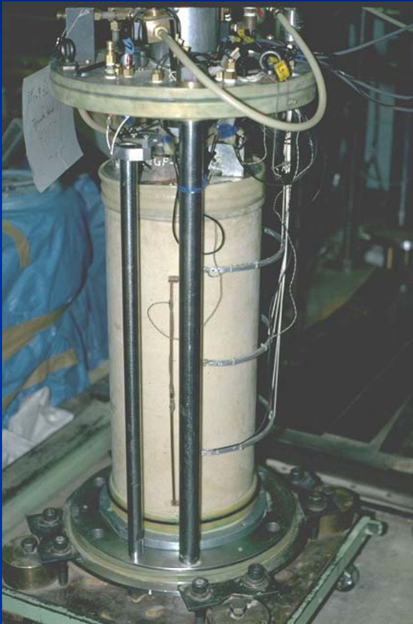
Прибор трехосного сжатия. Образец диаметром 30 см.
