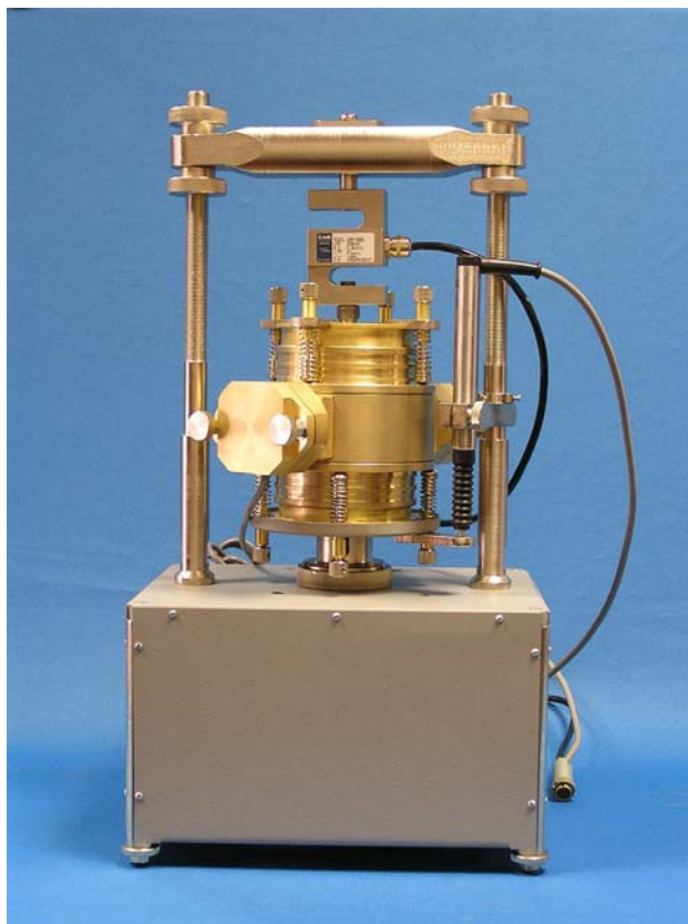
Рис. 1. Компрессионный прибор с измерением боковых напряжений
