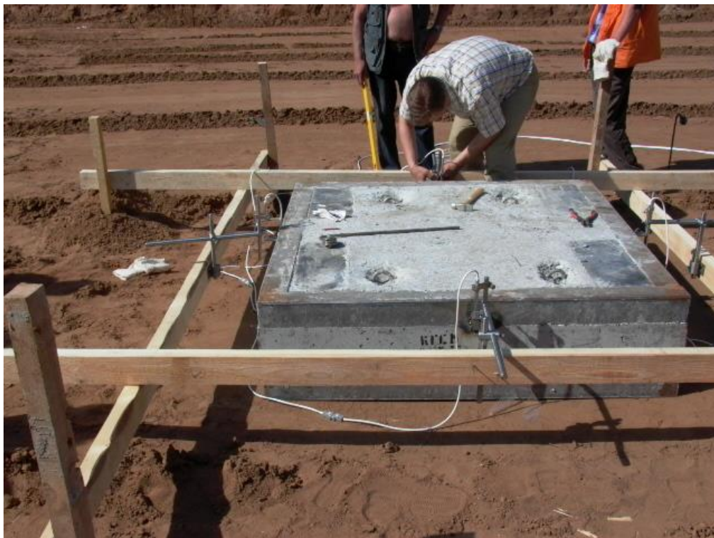
Рис. 7. Штамп площадью 22500 см 2
