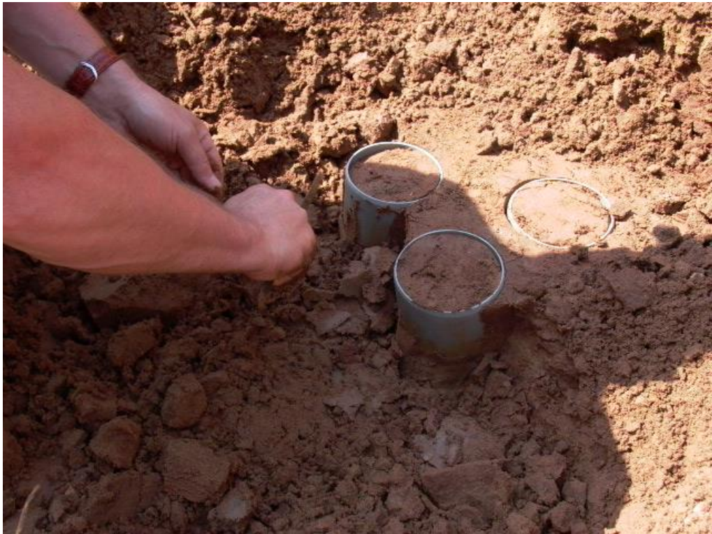
Рис. 6. Отбор монолитов супеси. Штамп номер 3.
