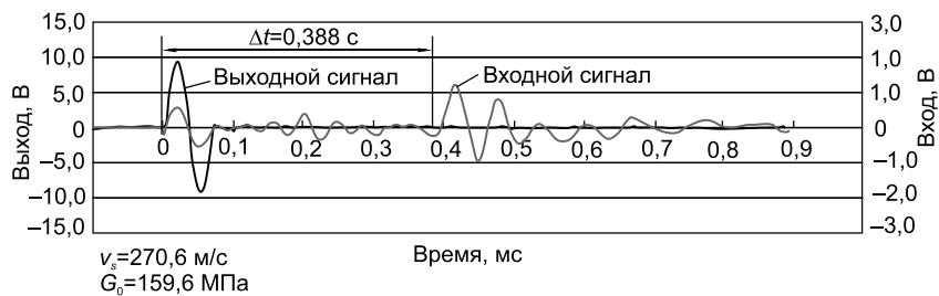
Рис. 10.13. Визуальное определение времени пути поперечной волны (Karg & Naegeman, 2005)
