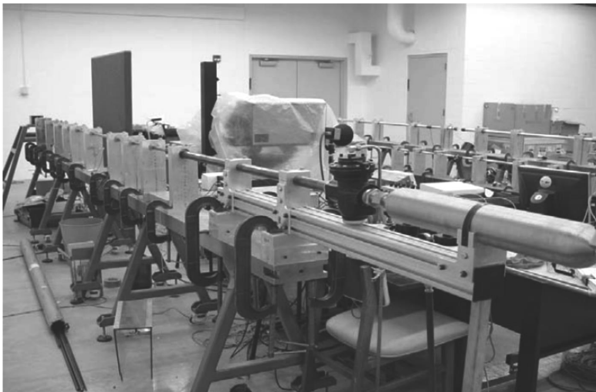
Рис. 6.1-9. Фото установки Кольского для динамических высокоскоростных испытаний (Kabir et al., 2010)
